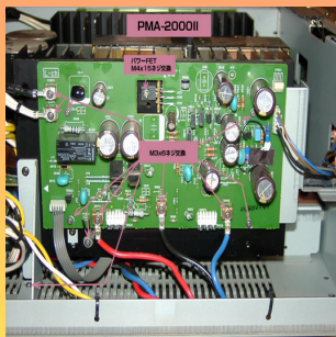
プリメイン・アンプ基板におけるネジ止め例
