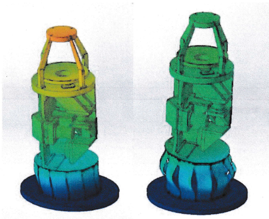
図 3.9: 全体系の主要な固有振動モード(左:39Hz、右:174Hz)[8]
